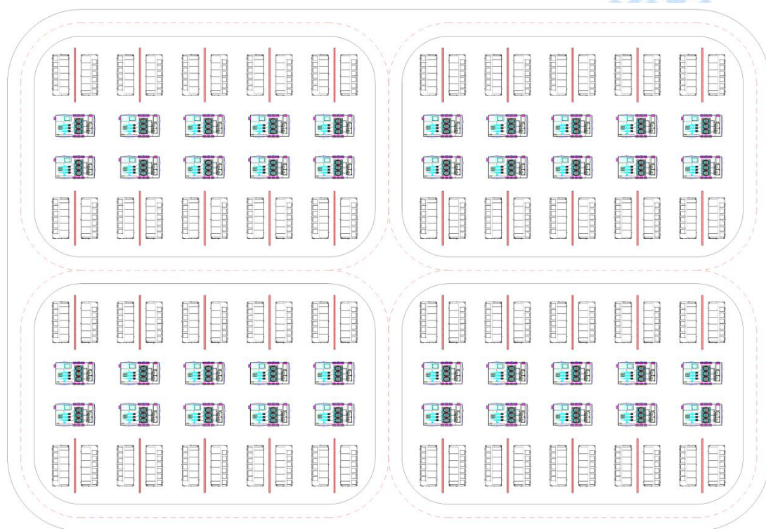
200MW/400MWh 布局示意图
