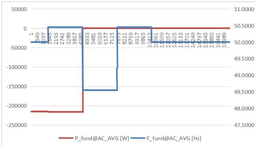
50.45Hz~48.55Hz (持续 1min) ~48.55Hz~50.45Hz 放电 f-T、P-T、Q-T 曲线
