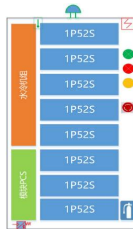
图 4-4 eBlock-418 内部结构图
